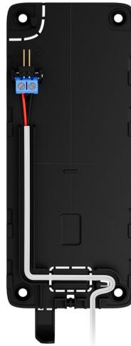
5. Schalten Sie das Bedienteil ein und setzen Sie es auf die Montageplatte.
