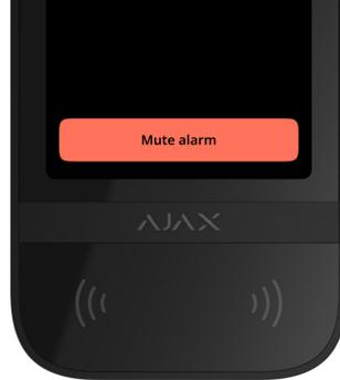
Wird im System ein Feualarm ausgelöst, kann dieser mit KeyPad TouchScreen stummgeschaltet werden.
