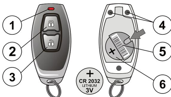
Abbildung: 1 – Signallampe; 2 – Taste zur Sicherung (Ein); 3 – Taste zum Entsichern (Aus); 4 – Schrauben der unteren Abdeckung; 5 – Seriennummer; 6 – Batterie CR2032 (entfernen Sie die Batterie durch Drücken in Pfeilrichtung).
