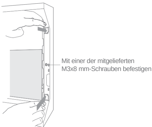
Abbildung 5: Positionieren der Halterung und der Platine
